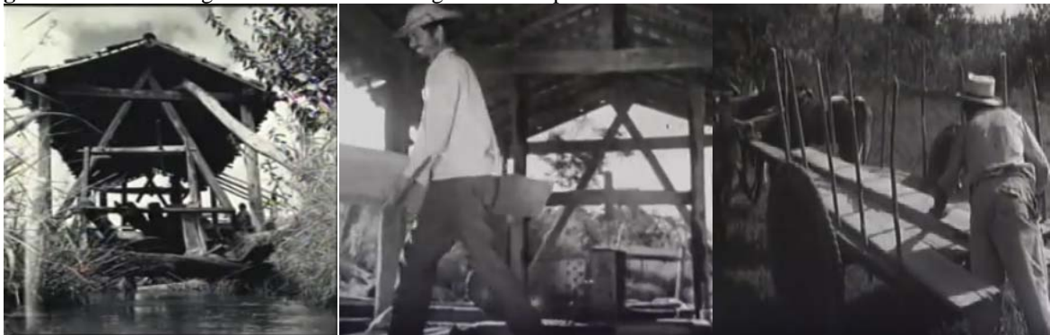
Figura 10 - Olhos d’Água: serraria movida a água e o transporte da madeira na comunidade.
