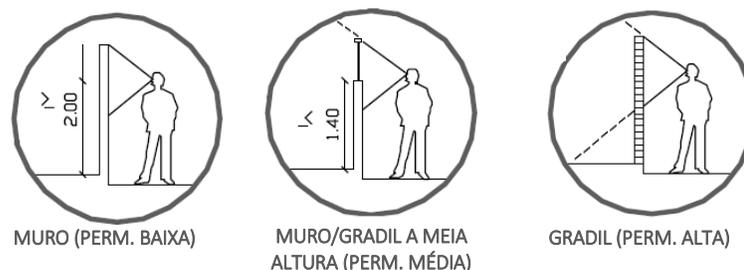
Figura 24 - Esquemas de permeabilidade baixa, média e alta utilizados para o levantamento.
