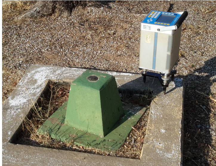
Figura 3.6: Estação base do IBGE(EG8070424) e o Gravímetro Scintrex CG-5 utilizado durante o levantamento.
