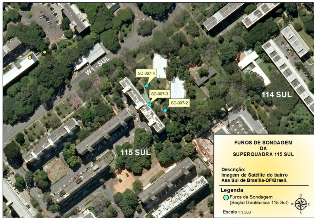
Figura 4. 4: Croqui com localização dos furos de sondagem utilizados para construção da seção geológico-geotécnica da 115 Sul.
