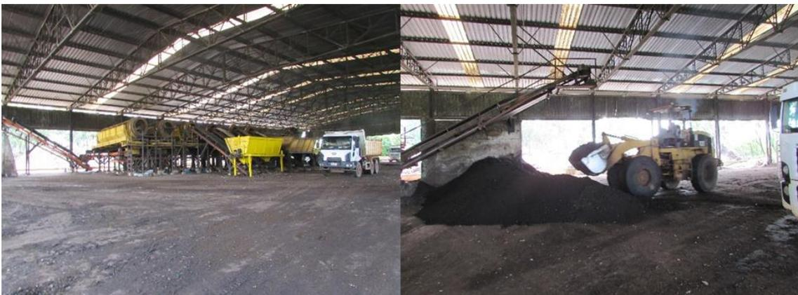
Figura 5.12 - Galpão de peneiramento de MSA e abastecimento dos caminhões da UCTL
