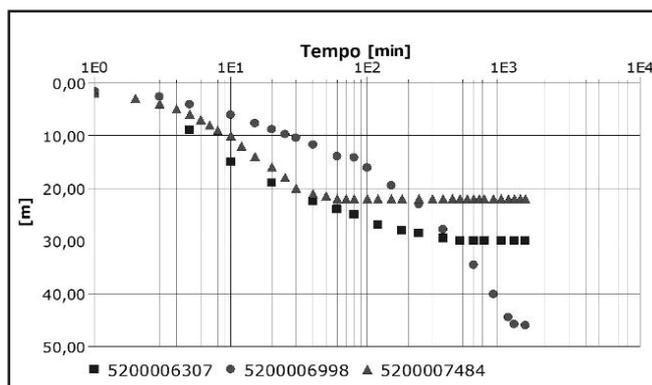
**Figura 13 - Gráfico rebaixamento x log-tempo de testes de bombeamento realizado no aquífero Diamantino**
