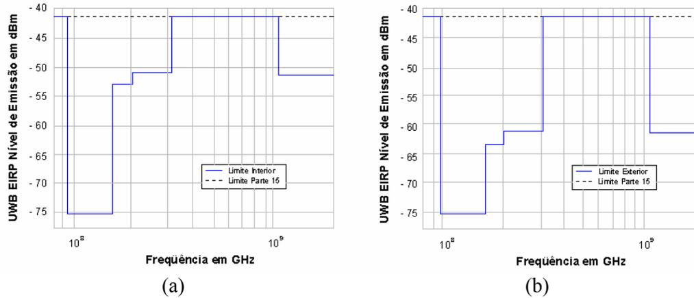
Figura 2.2 – Máscara Espectral para sistemas em ambientes (a) internos, (b) externos.
