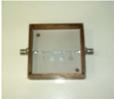
Figura 6.19 – Montagem do Filtro de 4 estubes em uma caixa.
