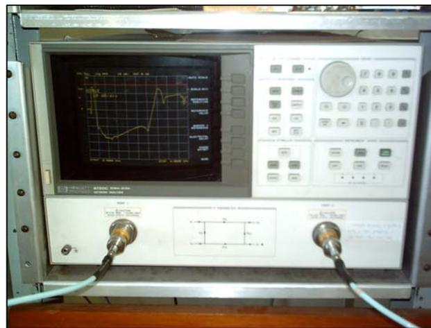
Figura 6.13 – Analisador de redes vetorial modelo HP 8720C usado para a medição dos filtros.
