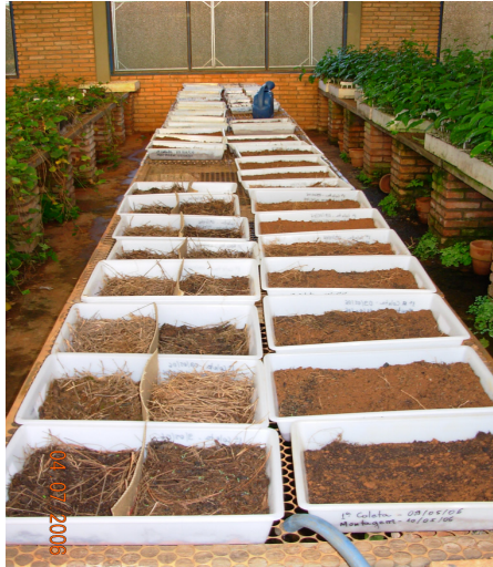
Figura 3.11: Disposição das bandejas com o solo e serapilheira coletados sob plantios de Pinus caribea com e sem corte, na área IV da Flona de Brasília - DF.
