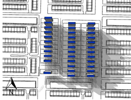
Figura 85 – Projeção de sombra da Classe 3, no solstício de inverno (22 de junho), das 12h às 16h.
