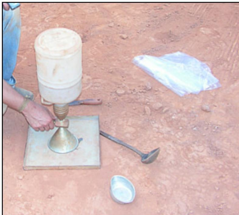
Figura 4.6 – Ensaio de Frasco de Areia
