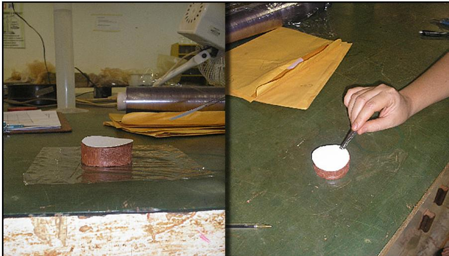
**Figura 4.21 – Estrutura formada pelos círculos de papel filtro e o corpo-de-prova moldado**
