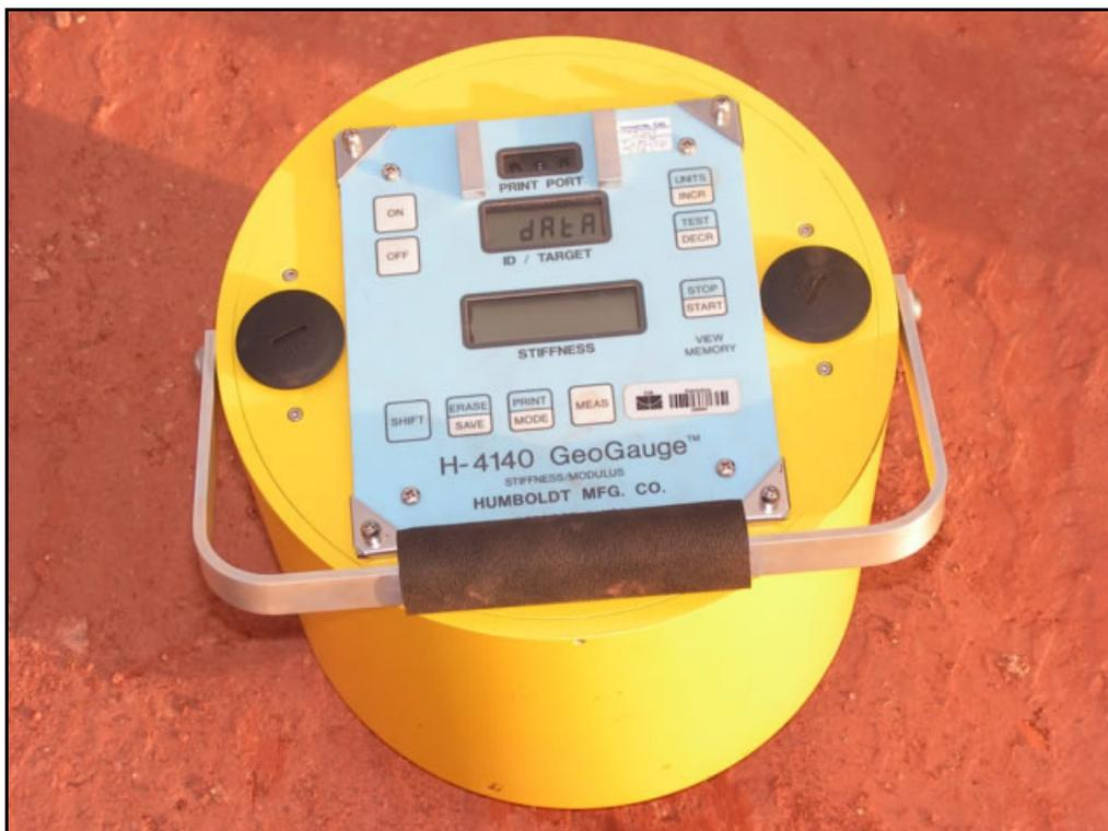
Figura 4.9 – Vista Superior do Equipamento GeoGauge
