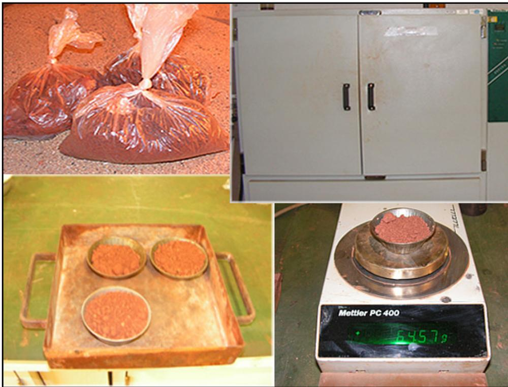
Figura 4.7 – Fases do Ensaio para a determinação da Umidade
