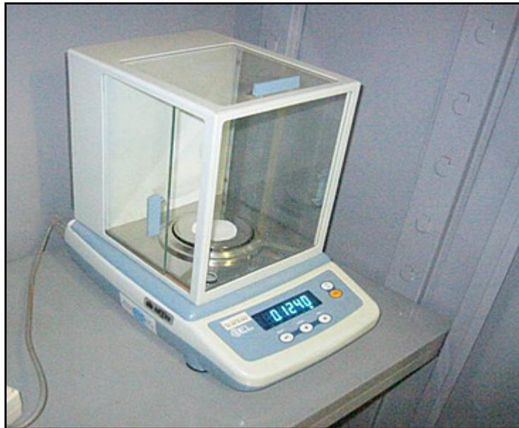
**Figura 4.23 – Balança para pesagem dos papéis filtro**
