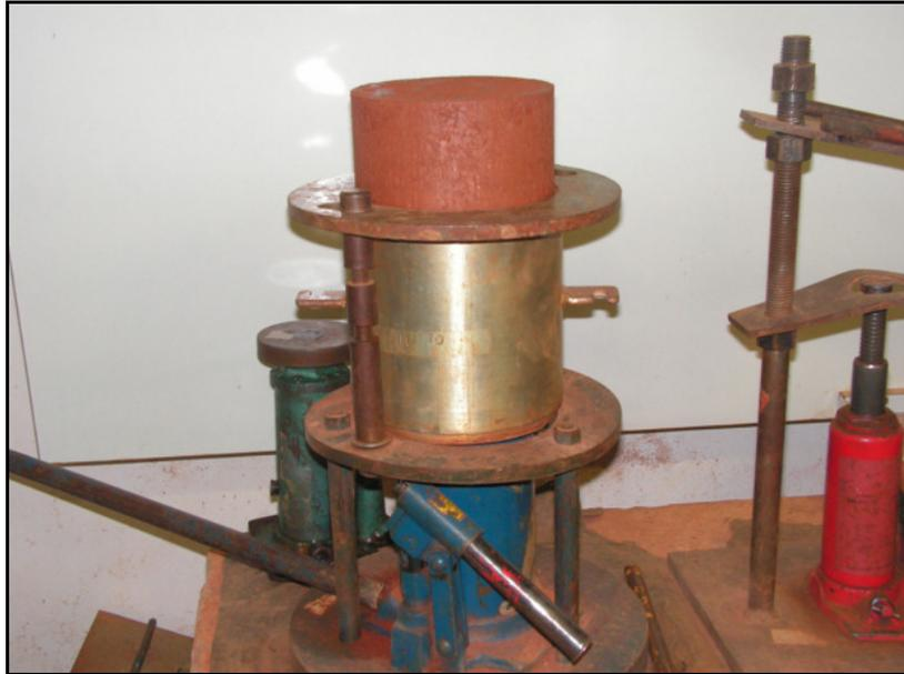
**Figura 4.18 – Extração do corpo-de-prova compactado**
