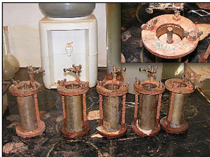
Figura 4.25 – Corpos-de-prova acoplados aos conjuntos de embebição
