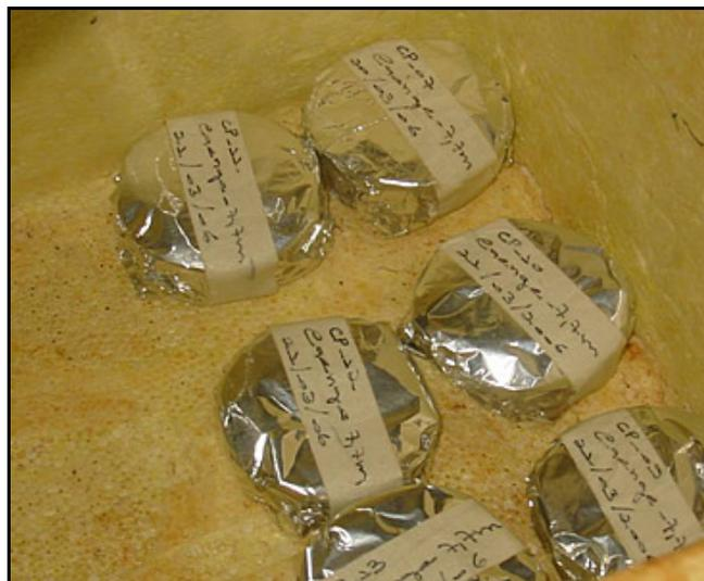
**Figura 4.22 – Corpos-de-prova fechados e acondicionados em caixa de isopor**
