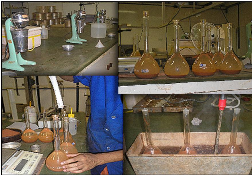
**Figura 4.15 – Ensaio para determinação da massa específica dos grãos**
