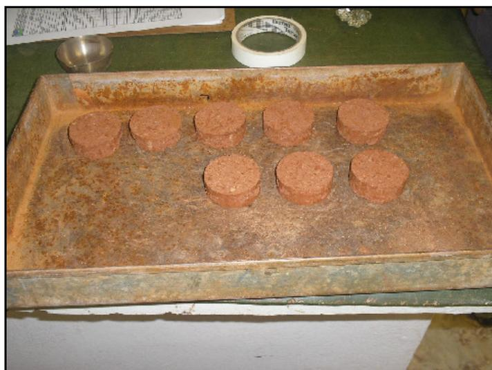
**Figura 4.20 – Corpos-de-prova moldados**
