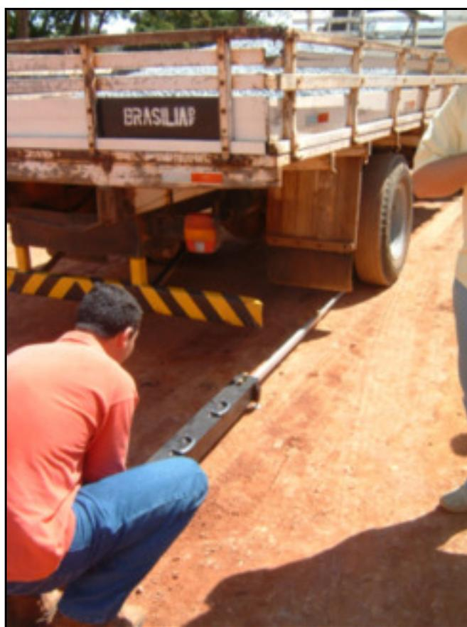
**Figura 4.8 – Ensaio de Viga Benkelman**
