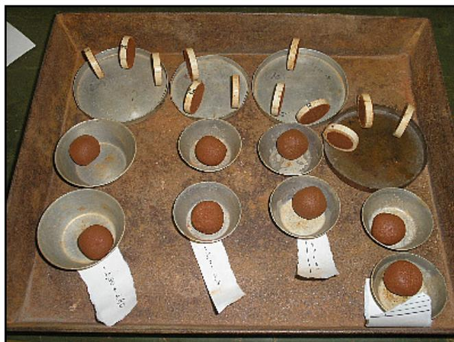
**Figura 4.17 – Secagem dos anéis e das bolinhas moldadas**
