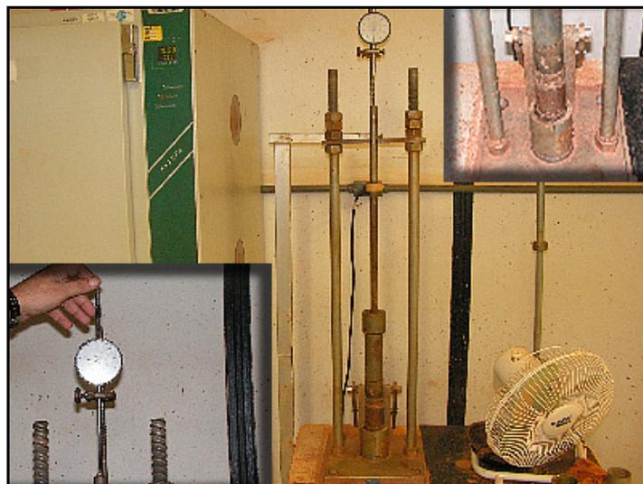
Figura 4.24 – Equipamento de compactação Mini-MCV
