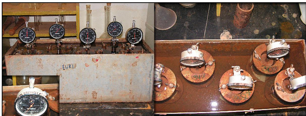
Figura 4.26 – Corpos-de-prova submersos (vista frontal e superior) no tanque de imersão e detalhe do extensômetro acoplado ao conjunto de imersão
