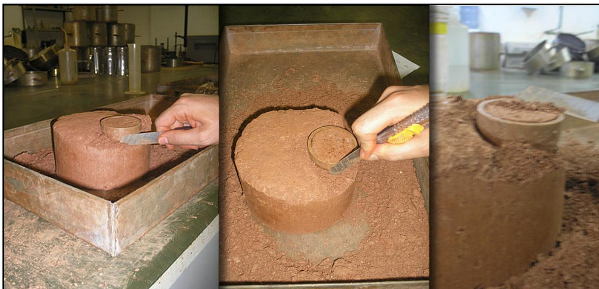
**Figura 4.19 – Moldagem dos corpos-de-prova**
