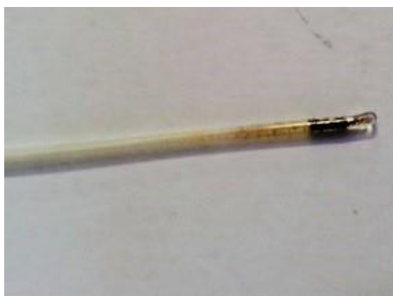
Figura 14. Composto 4p após atingir a temperatura 217 °C com aspecto carbonizado.
