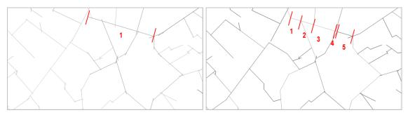
Figura 3.8 - Recorte ilustrativo da diferença entre um mapa axial (à esquerda, com suas interseções salientes) e um mapa de segmentos (à direita, cada interseção deu origem a um nó e um eixo foi dividido em vários segmentos).
