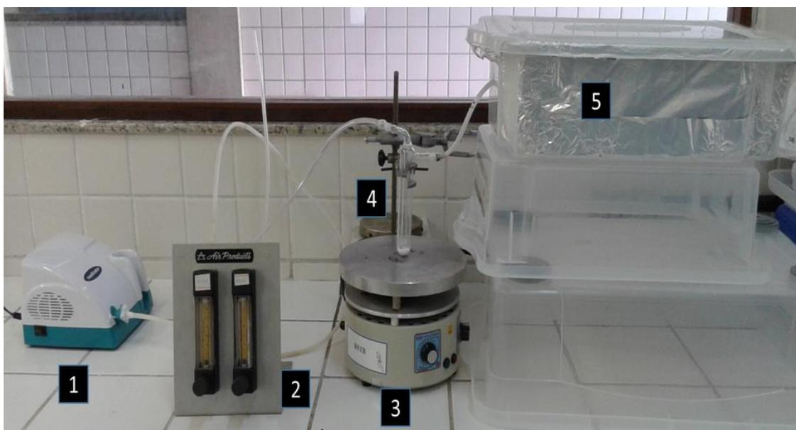
Figura 9 – Sistema 2: Compressor de ar (1); Fluxômetro (2); Agitador (3); Trap (4); Câmara de inalação (5)
