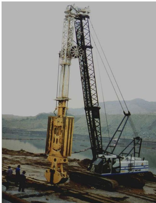
Figura 4.24 – *Clamshell* de caçamba hidráulica montada em *kelly* (Assis, 2005).
