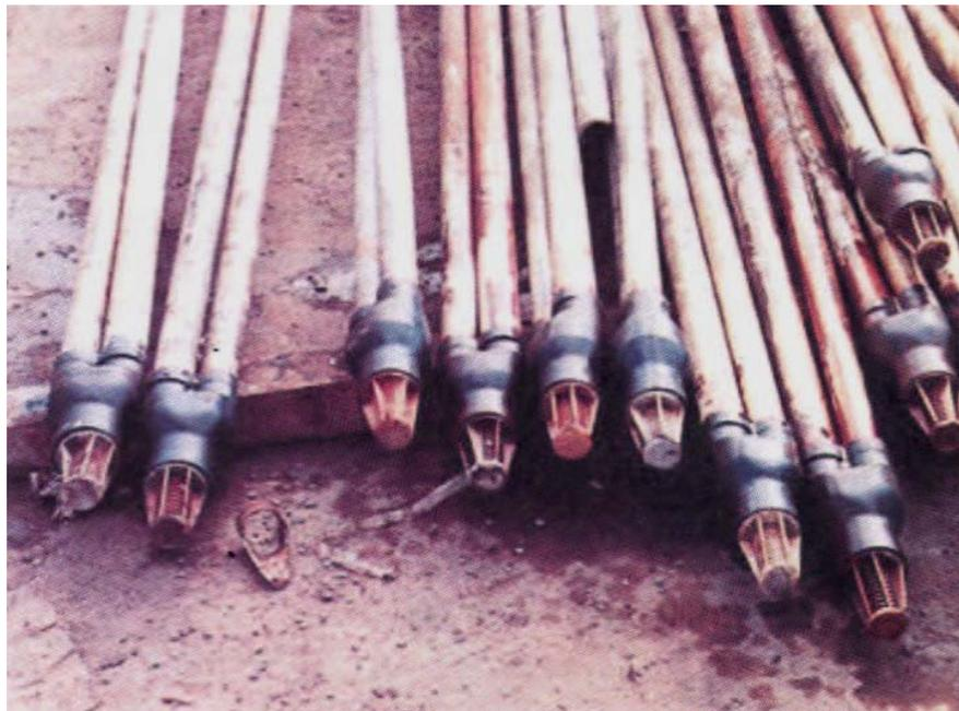
Figura 4.39 – Injetores montados na tubulação (Tecnogeo, 2005).
