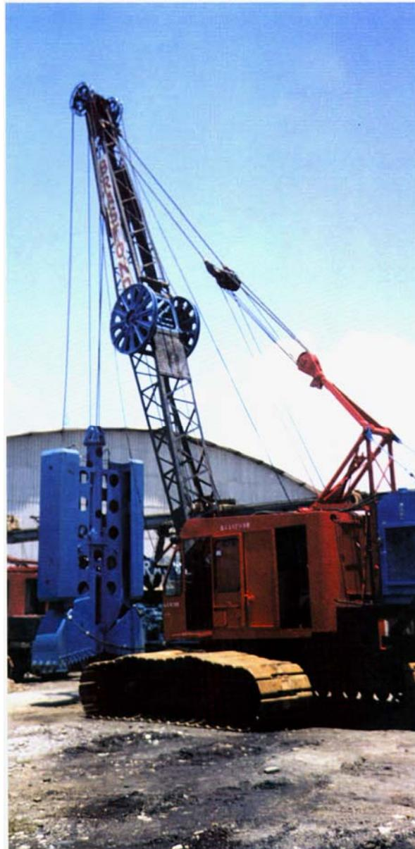
Figura 4.23 – *Clamshell* hidráulico (Brasfond, 2007b).
