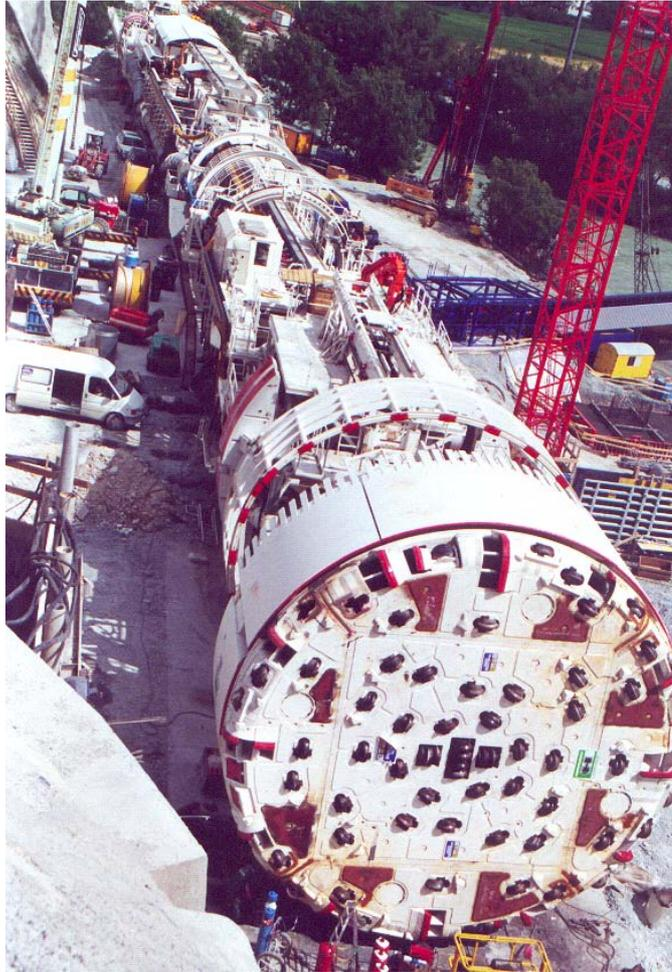
Figura 4.2 – Tuneladora para perfuração em maciços rochosos (Assis, 2005).
