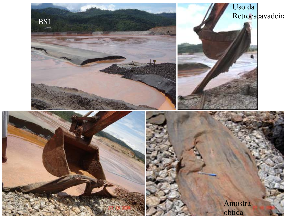
Figura 3.15: Exumação da amostra de geotêxtil na baía de secagem número 1 (BS1), da barragem do Germano, da UIG / Samarco.
