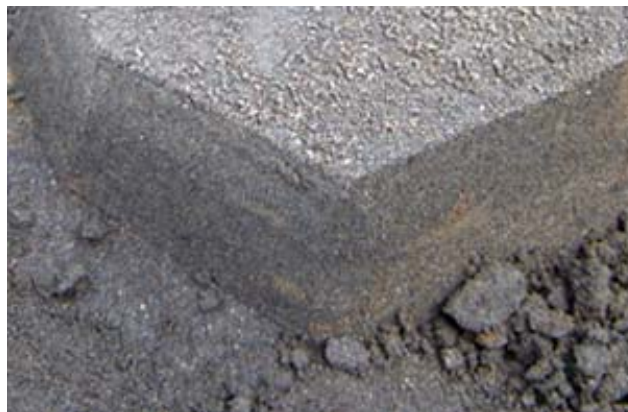
Figura 4.4: Perfil vertical verificado na superfície da área compactada do barramento da BL1 (CMT).
