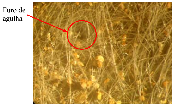
Figura 5.68: Imagem superficial do G1 coletado após o ensaio de GR do sistema FAG1.
