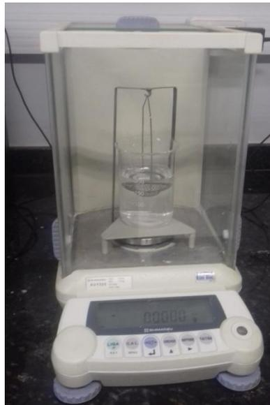
**Figura 3.4** Balança de precisão SHIMADZU AUY 220.
