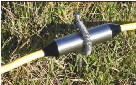
Figura 4. a) Medidor de resistividade terrestre Sting-Swift R1 IP (Advanced Geoscience, Inc), b) cabos contendo 56 eletrodos ao longo do transecto linear de 275 m, c) eletrodos individuais mantidos presos na superfície do solo por estacas de aço inoxidável, inseridas no solo
