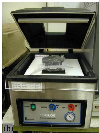
Figura 3.7 – (a) Equipamento CoreLok® utilizado para auxiliar na determinação do índice de vazios das misturas com altos valores; (b) amostra selada (Allen Cooley et al. 2002).
