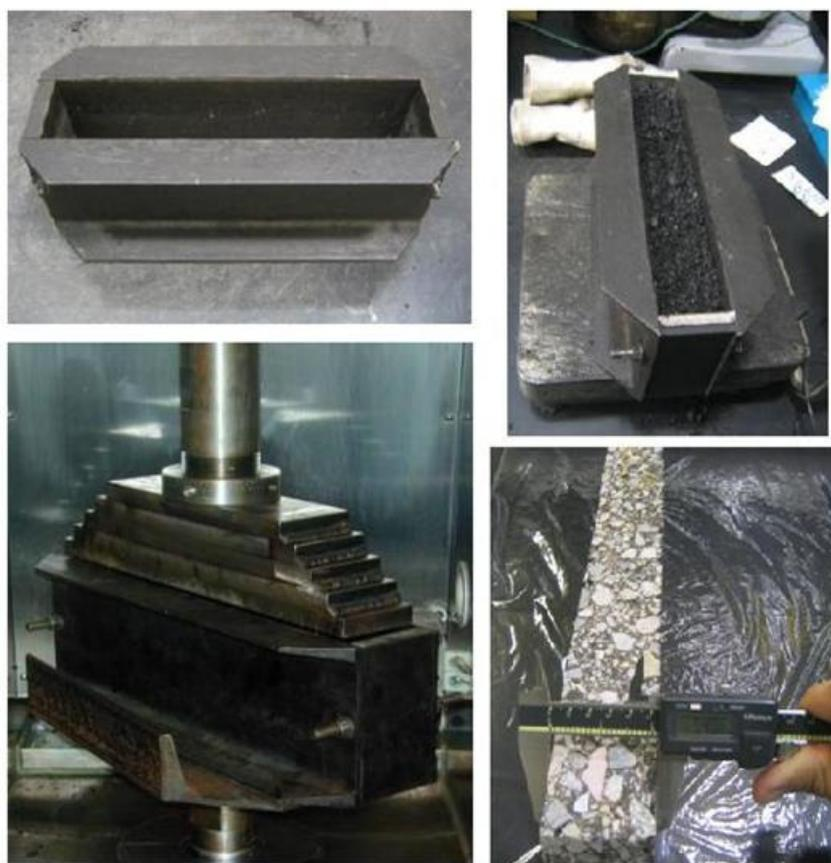
Figura 3.6 – Procedimento para produção dos corpos de prova utilizados nessa pesquisa.
