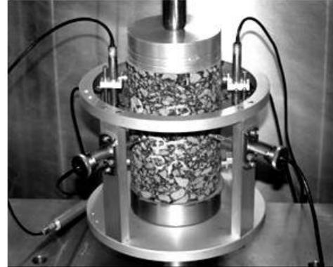
Figura 2.2 – Esquema de um ensaio com solitação harmônica em um material viscoelástico.
