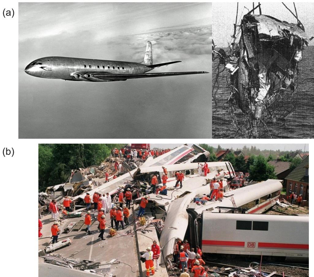
Figura 1.1 - Exemplos de catástrofes devido à falha por fadiga: (a) aeronave Comet e (b) trem de alta velocidade ICE-884.
