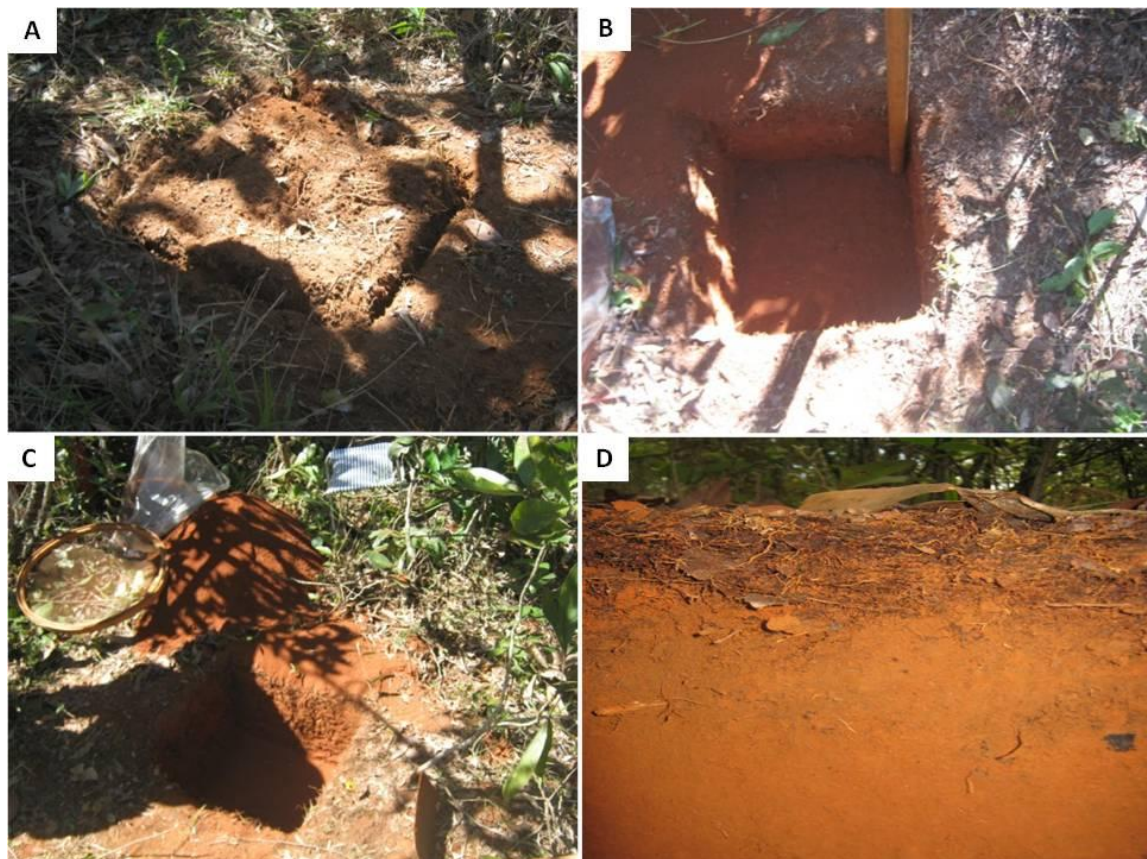
Figura 5 - Amostragem da biomassa radicular em campo. A: Delimitação do monólito antes da escavação; B e C: Monólito escavado nas dimensões de 50 x 50 x 30 cm; D: Detalhe da porção superior do monólito.
