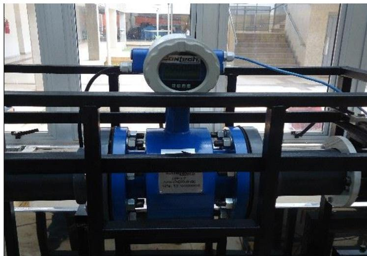
Figura 20. Sensor de vazão eletromagnético montado na bancada.
