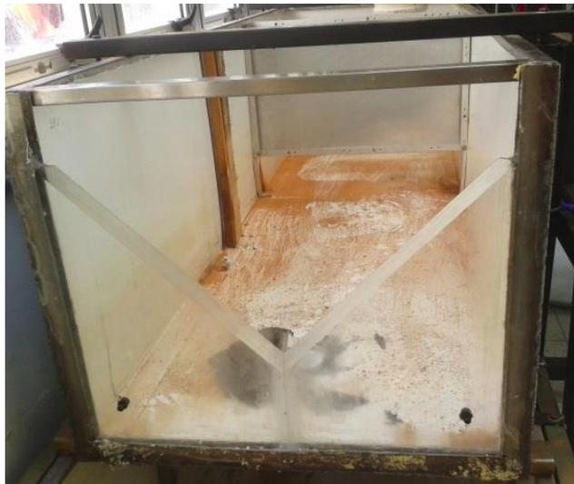
Figura 17. Vertedor Triangular usado na bancada.
