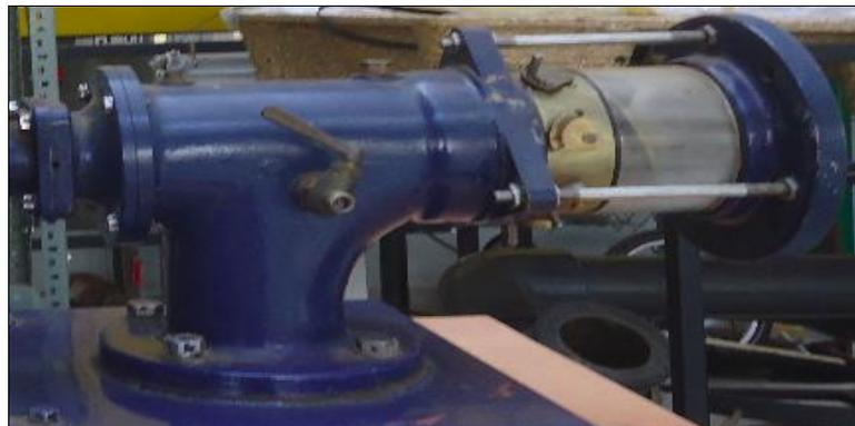
Figura 3. Turbina Kaplan
