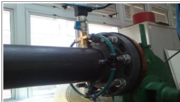
Figura 21. Sensor de pressão de 2.5 bar instalado na entrada da turbina Indalma
