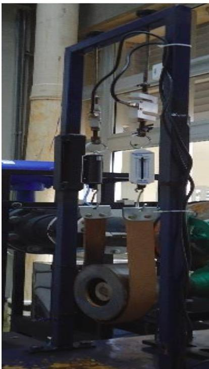
Figura 16. Freio de Prony instalado na bancada.
