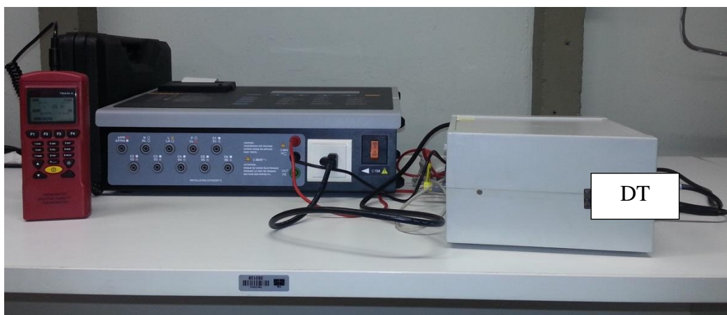
Figura 15. Conexões para análise de segurança elétrica do DT.
