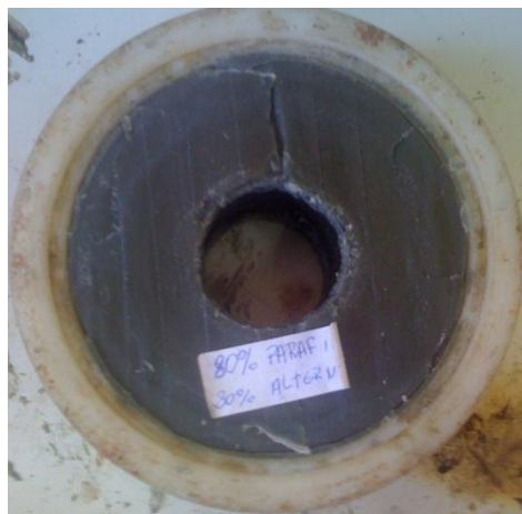
Figura 4.10: Detalhe do grão confeccionado com 80% parafina derivada de petróleo e 20% de parafina alternativa
