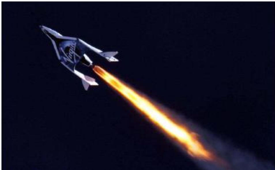
Figura 1.2: Teste do motor (híbrido) de 250 kN da nave SpaceShip Two
