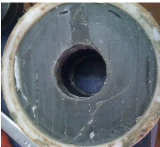
Figura 4.11: Detalhe do grão confeccionado com 85% de parafina derivada de petróleo e 15% de parafina alternativa
