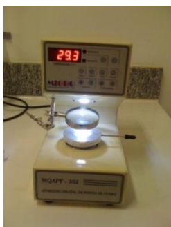
Figura 3.1: Medição do Ponto de fusão do IQ/UnB
