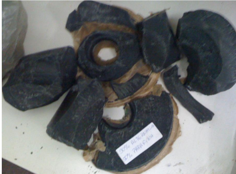
Figura 4.9: Grão confeccionado com 50% parafina derivada de petróleo e 50% parafina alternativa
