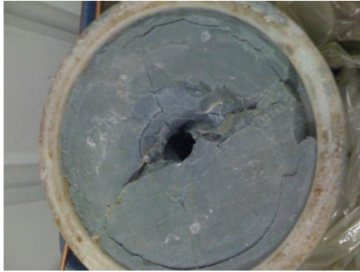
Figura 4.7: Vista do grão formado com 50% parafina, 25% Óleo de babaçu e 25% parafina alternativa.
