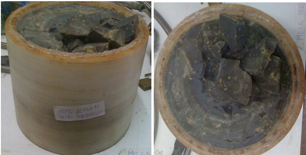
Figura 4.6: Grão formado por 50% de parafina alternativa com 50% de óleo de babaçu.
