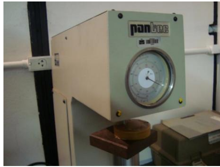
Figura 3.5: Ensaio de dureza de Rockwell Fonte: Santos, F. R. P. dos e Gomes, R. C (2010)
