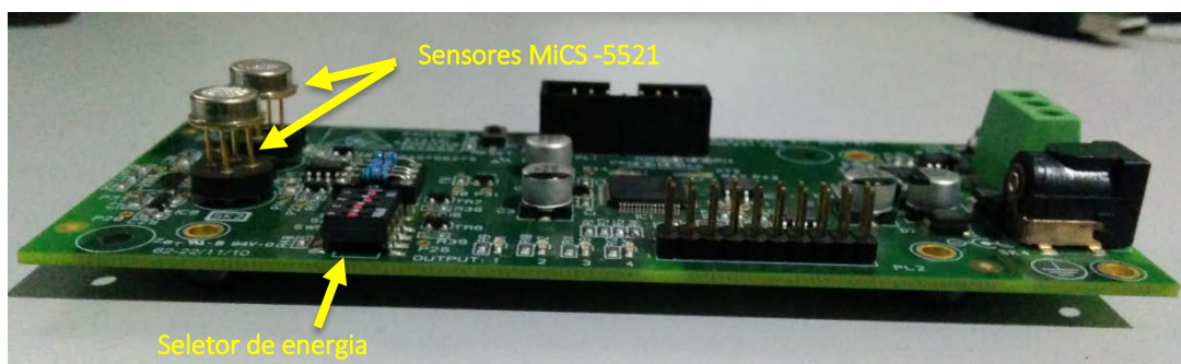
Figura 37. Detalhe da placa de avaliação do kit MiCS – EK1 com a localização dos slots com os sensores MiCS - 5521 e o chaveamento de energia (seletor) posição high .
