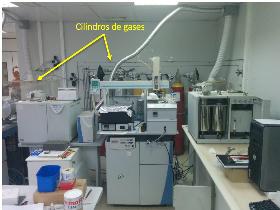
Figura 23. Detalhe da estrutura do sistema de gases confinados do laboratório.
