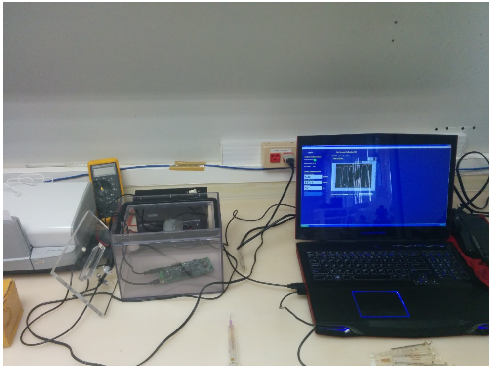
Figura 29. Box de teste de gases (SR#3) com o kit MiCS - EK1 conectado ao software de avaliação.
