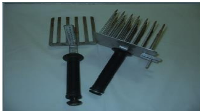
Figura 2.1- Equipamento utilizado para a coleta de solo conhecido como Medidor de Camada de Serapilheira ou Porco Espinho.
