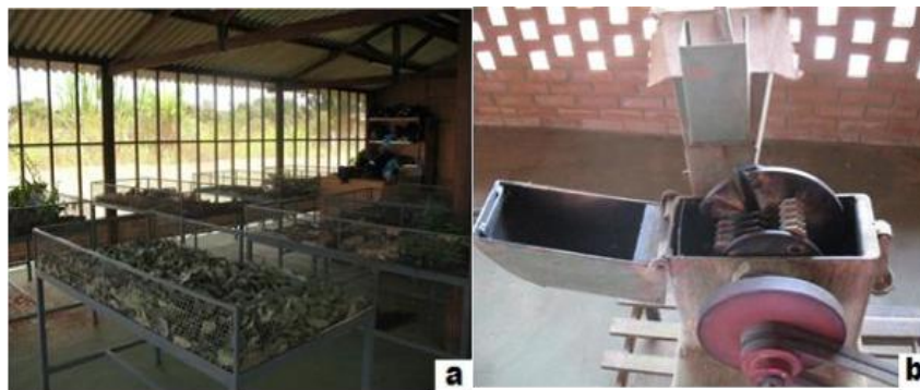
Figura 24 – (a) Dessecação e estabilização dos órgãos vegetais. (b) Moinho de facas utilizado para pulverização dos órgãos vegetais. Fonte: Arquivo do Laboratório de Farmacognosia/UnB
