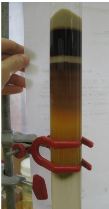
Figura 35 – Fracionamento em coluna aberta de sílica da amostra de 3,15 g, proveniente do extrato acetato de etila da casca da raiz de Astronium fraxinifolium .
