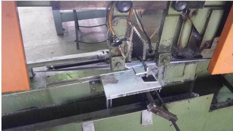
Figura 3.11 - Franho FM 500 em corte de junta tipo T.
