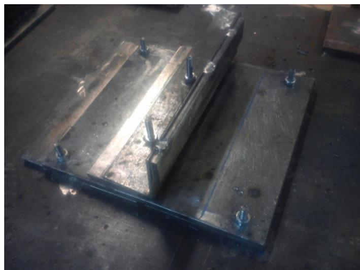
Figura 3.5 - Base para suporte da junta tipo T a ser soldada.
