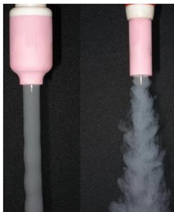
Figura 2.19 - Da esquerda para a direita, bocal e difusor do tipo *gas lens*, e bocal padrão, respectivamente, ambos utilizados em TIG.
