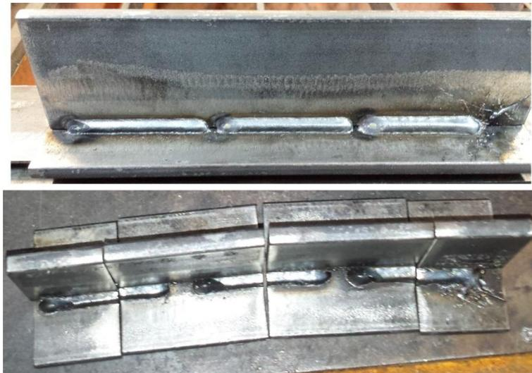
Figura 3.12 - Cordão de solda intermitente e junta seccionada.
