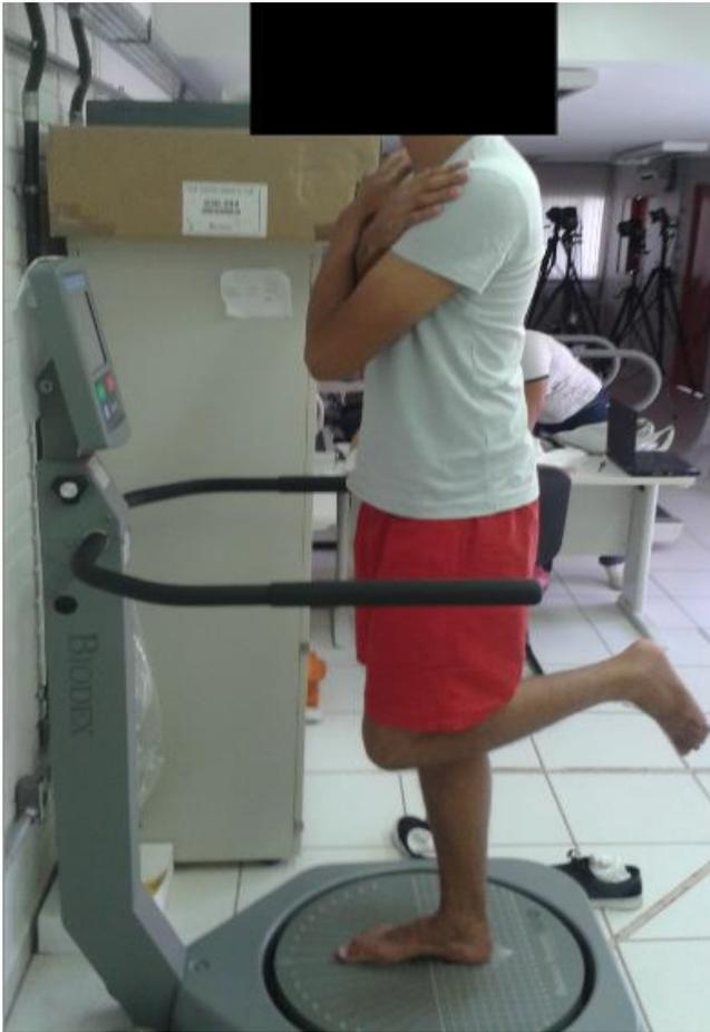
**Figura 3:** Ilustração da plataforma de equilíbrio *Balance System* utilizado na pesquisa, e posicionamento do voluntário.
