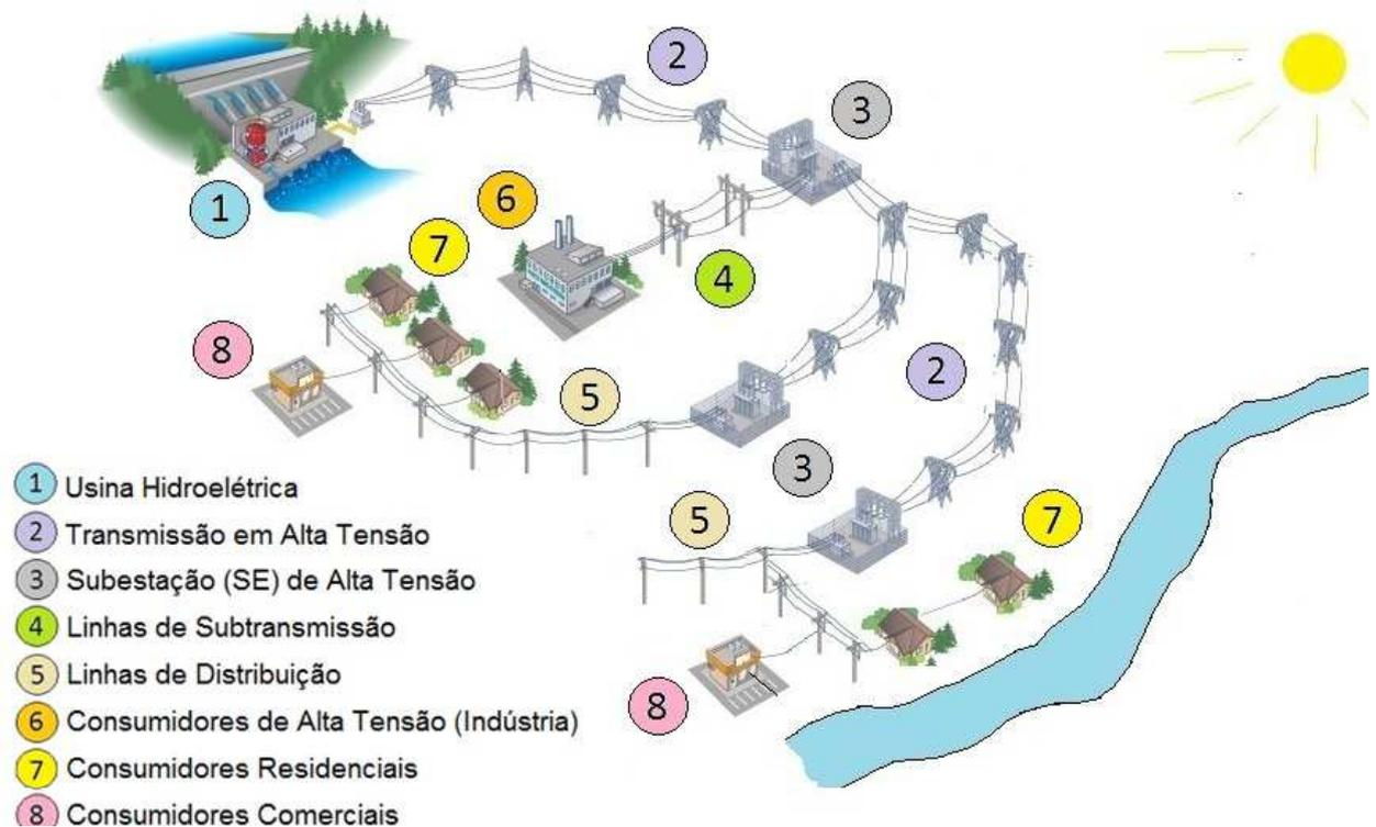
Figure 1.1: Esquema reduzido do sistema elétrico, compreendendo geradores hidrelétricos distantes, longas linhas de transmissão, distribuição e consumo
