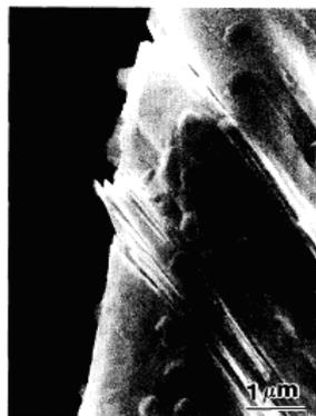
Figura 10 - Extrusões e intrusões em uma chapa de cobre (MEYERS, 1998).
