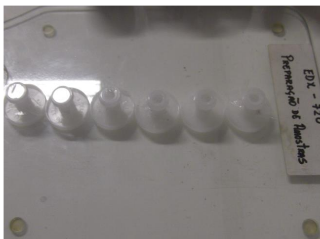
Figura 2: Recipientes de plástico lacrados (porta amostras) com amostras de cinzas de sementes de Dalbergia miscolobium Benth.
