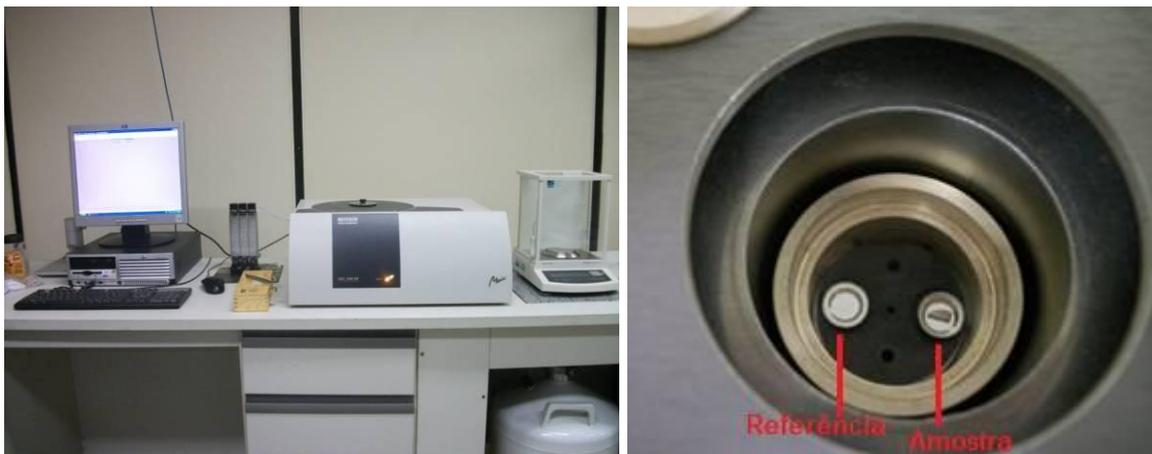
**Figura 53** - Calorímetro DSC Netzsch 200 F3 Maia e cadinhos de alumínio usados no ensaio.
