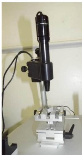
**Figura 59** - Microscópio Óptico – CSM Calowear.
