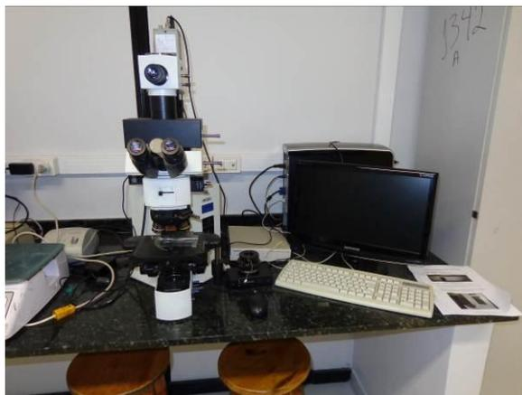
**Figura 50** - Microscópio Óptico Olympus BX51 e máquina Sony SSC-DC50A.
