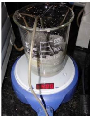
**Figura 57** - Lama abrasiva no agitador magnético.
