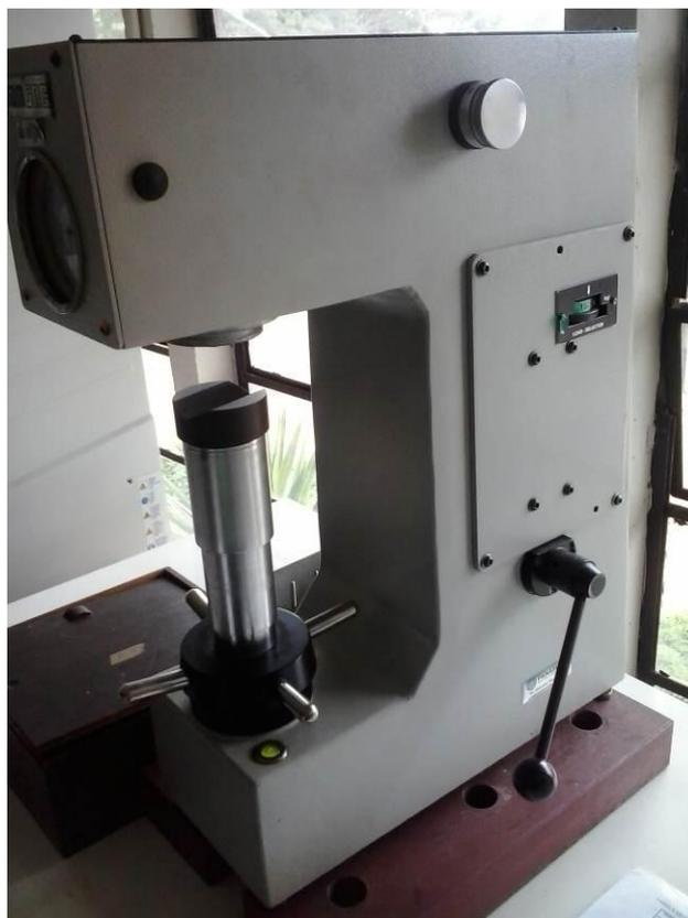
**Figura 54** - Durômetro ZHU250 fabricado pela Zwick/Roell.
