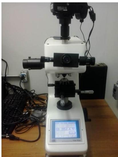
**Figura 55** - Micro durômetro FM 700 fabricado pela Future Teck.
