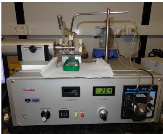
**Figura 56** - Equipamento de Teste por desgaste Microabrasivo CSM Calowear.
