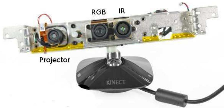
Figura 5. Dispositivo *Kinect*®. Adaptado de Teixeira et. al. (2011)
