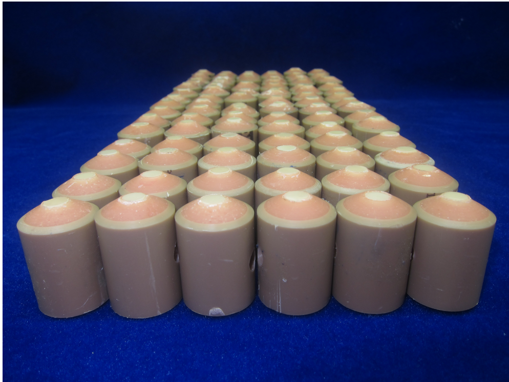
Figura 1 – Imagem dos corpos-de-prova utilizados, constituídos por disco cerâmico incluído em resina acrílica no interior de um tubo de PVC.
