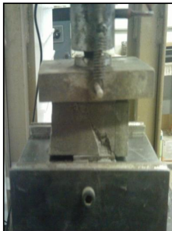
Figura 4.6 Corpo de prova rompido à tração na flexão utilizado no ensaio à compressão.
