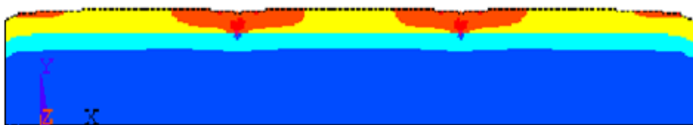
Figura 6.28 Tensões atuantes no Sistema de Revestimento na direção “x” na primeira meia hora.
