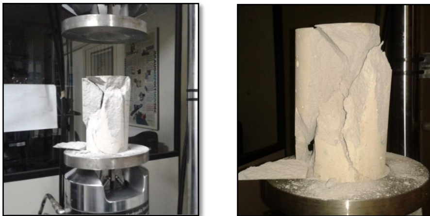
Figura 4.15 Corpos de prova fraturados.
