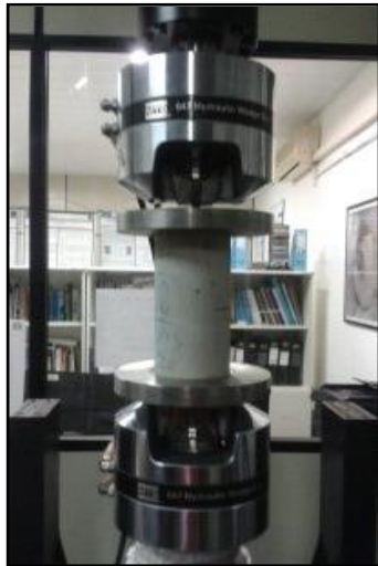
Figura 4.13 (a) Ensaio de Fadiga à Compressão, (b) Corpos de prova ensaiados à Fadiga a compressão com ruptura longitudinal na parte central.
