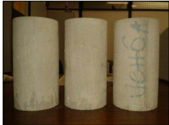
Figura 4.13 (a) Ensaio de Fadiga à Compressão, (b) Corpos de prova ensaiados à Fadiga a compressão com ruptura longitudinal na parte central.
