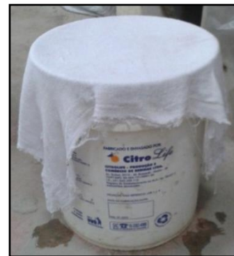
Figura 4.10 Pano úmido, para evitar a perda da água.
