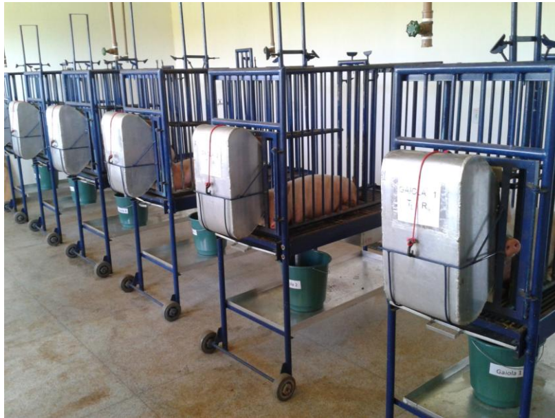
Figura 2. 1 Gaiola Metabólica utilizada no experimento, evidenciando a parte da frente de coleta das sobras de ração, o comedouro, e os baldes de coleta de urina.
