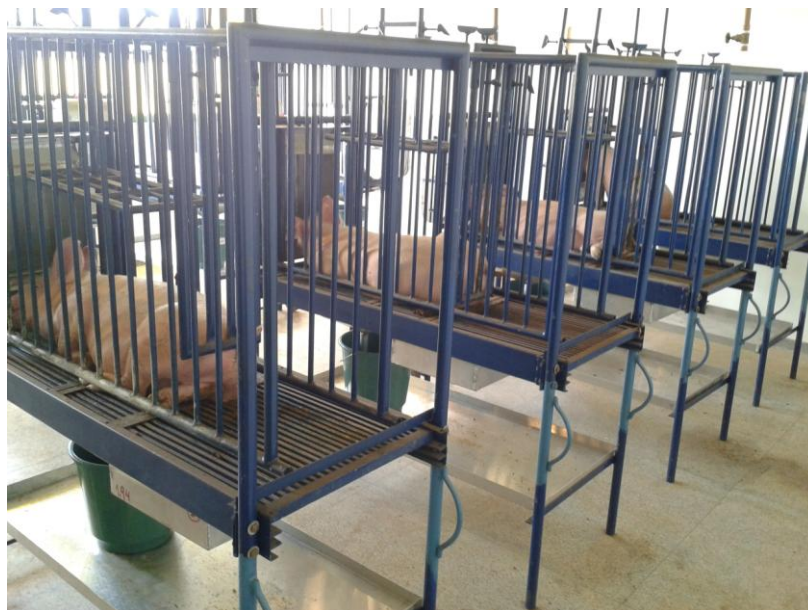
Figura 2. 2 Gaiola Metabólica utilizada no experimento, evidenciando a parte da de trás com as gavetas de alumínio para coleta de fezes.
