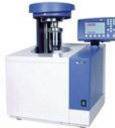
Figura 2. 4 Bomba calorimétrica automática C-2000, marca IKA WORKS, usada para análise de energia da urina.
