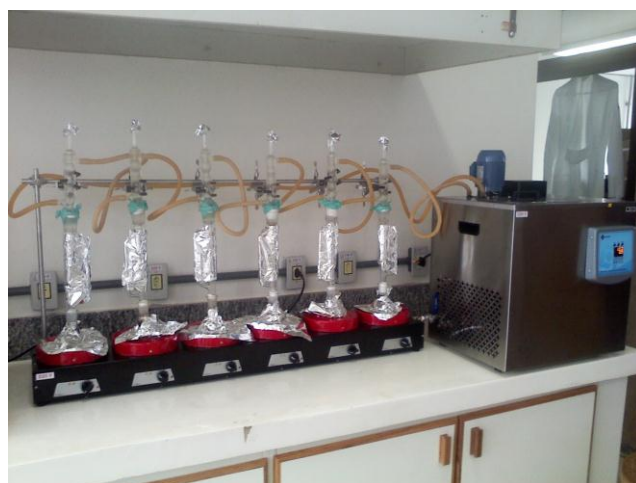
Figura 3.2. Sistema utilizado na extração de PCB das amostras de sedimentos. Disponível no laboratório do grupo de pesquisa em Automação, Quimiometria e Química Ambiental (AQQUA) da Universidade de Brasília. Fotografia de arquivo do autor.
