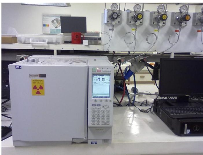
Figura 3.6. Cromatógrafo Gasoso com Detector por Captura de Elétrons Shimadzu CG-2010 da Central Analítica do Instituto de Química da Universidade de Brasília. Fotografia de arquivo do autor.
