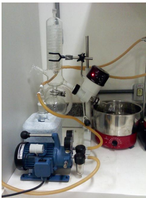
Figura 3.3. Sistema utilizado para a concentração das amostras em evaporador rotativo com banho de aquecimento e em atmosfera de vácuo. Disponível no laboratório do grupo de pesquisa em Automação, Quimiometria e Química Ambiental (AQUA) da Universidade de Brasília. Fotografia de arquivo do autor.
