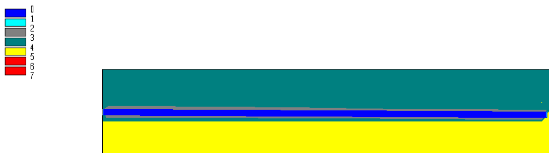
Figura C.17. Tensão principal menor em um plano longitudinal nas adjacências do túnel (MPa).
