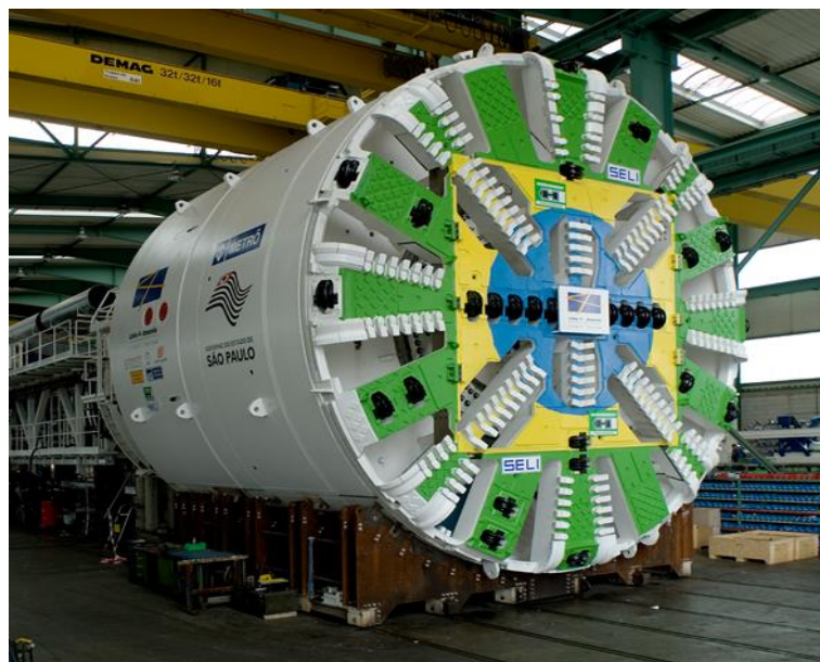
Figura 2.16. Tuneladora EPB utilizada na abertura dos túneis da Linha 4 do metrô de São Paulo (Assis, 2010).
