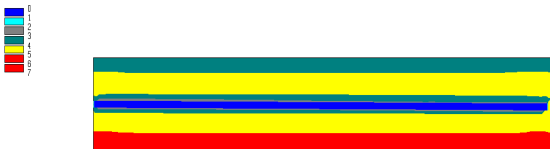
Figura C.29. Tensão principal menor em um plano longitudinal nas adjacências do túnel (MPa).
