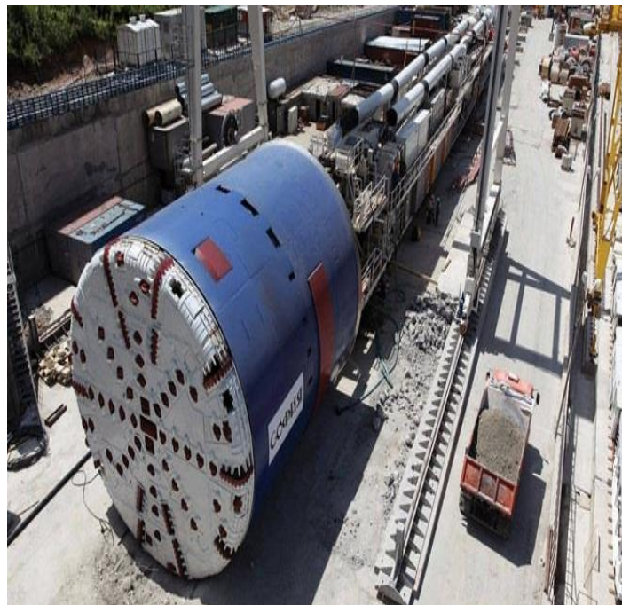
Figura 2.13. Cabeça de corte e duplo escudo da tuneladora Double Shield (Interbering, 2012).
