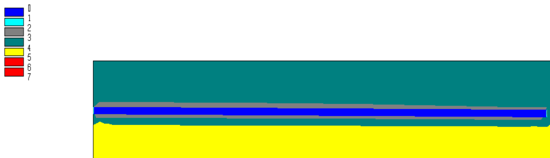
Figura C.5. Tensão principal menor em um plano longitudinal nas adjacências do túnel (MPa).
