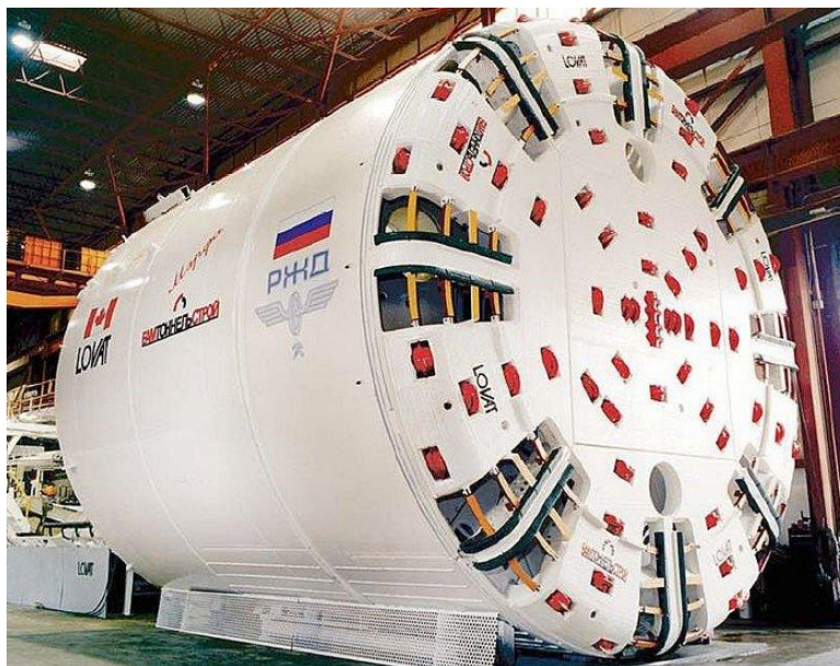
Figura 2.10. Cabeça de corte e escudo da Single Shield TBM (Caterpillar, 2012).
