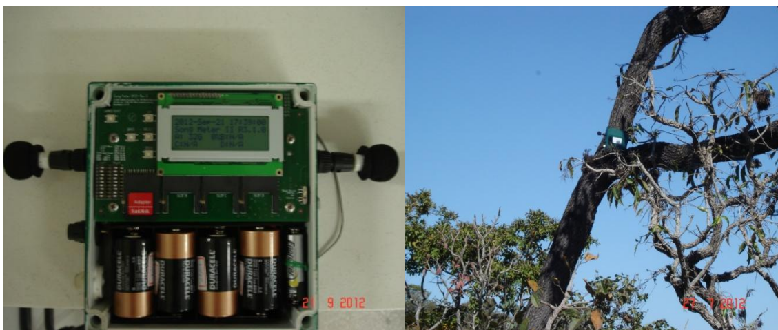
Figura 2- Gravador SongMeter SM2+ sem capa protetora à esquerda e gravador instalado em forquilha de árvore à 3 metros de altura.
