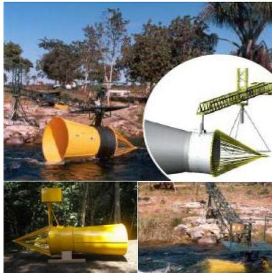
Figura 4.1: Turbina hidrocínética.
