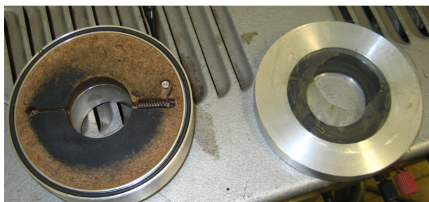
Figura 3.19 – Dispositivo de fio quente usado no TC100.
