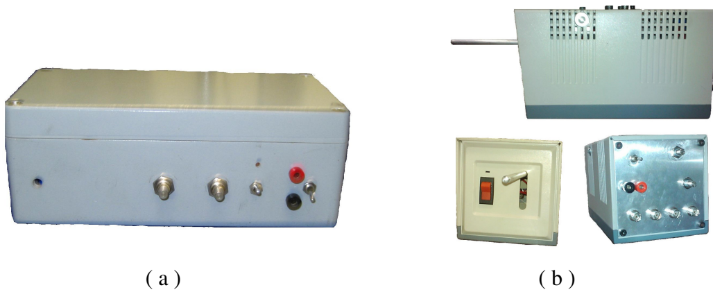
Figura 3.27 – Geradores de degrau de tensão. (a) Dispositivo do LMD-ENSAM; (b) Dispositivo do LMD-UnB.
