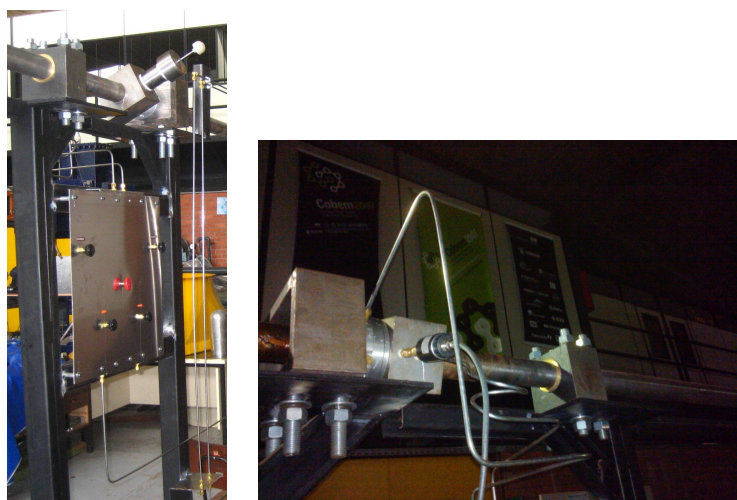
Figura 3.48 – Quadro de controle de pressurização e despressurização do TCFB. No detalhe, as conexões pneumáticas de alimentação e de medição de pressão.
