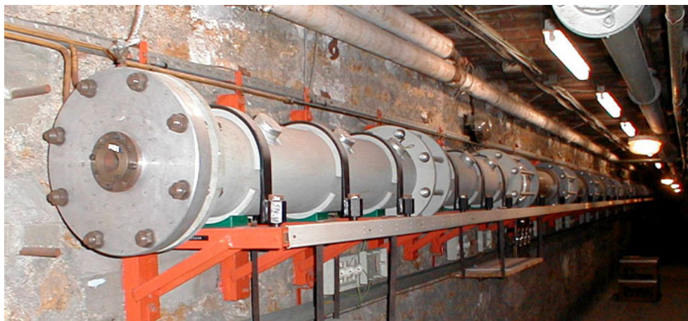
Figura 3.42 – Tubo de choque de referência (TCR) utilizado na calibração em baixas pressões.
