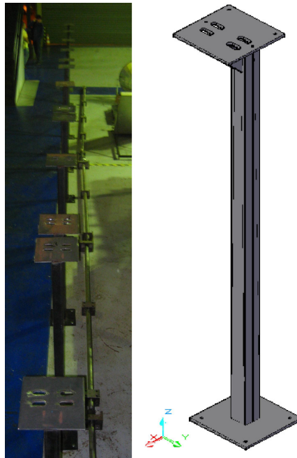
Figura 3.44 – Pilares de sustentação com as bases do TCFB instalados no LMD-UnB.
