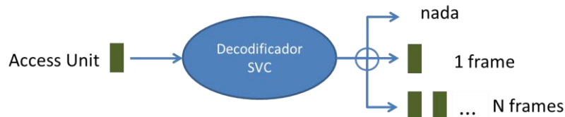
Figura 11 – Saída do decodificador SVC para cada interação de AU
