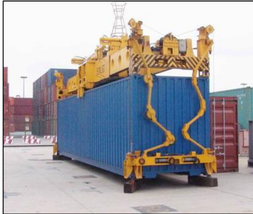
Figura 3.2 - Spreaders Fonte: www.zpmc.com
