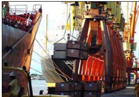
Figura 3.1 - Guindaste pórtico (elétricos) sobre trilhos
