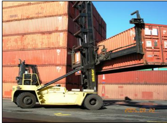
Figura 3.4 - Empilhadeira com capacidade superior a 30 ton. Fonte: www.ieeforklift.com
