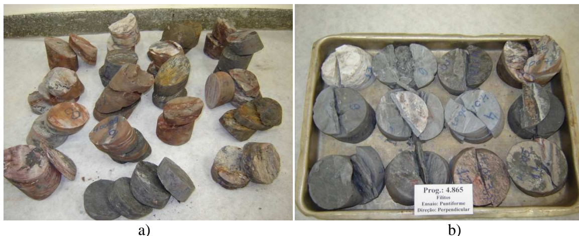
Figura B.1 - Registro fotográfico do ensaio de resistência puntiforme –filito-. a) dir. paralela b) dir perpendicular. (Furnas, 2009).
