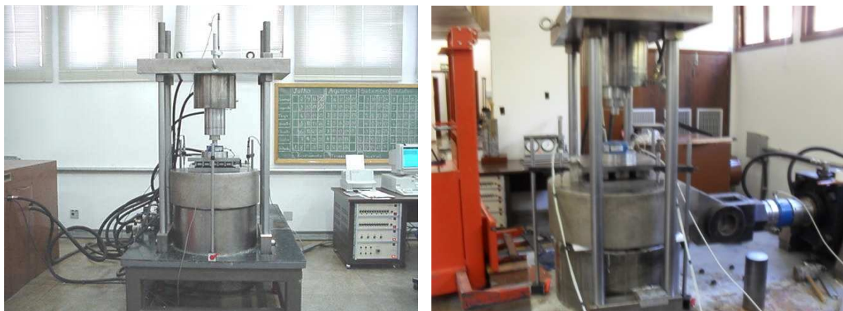
Figura 5.95 - Equipamento para ensaio de cisalhamento direto 30x30(cm). (Furnas, 2009).
