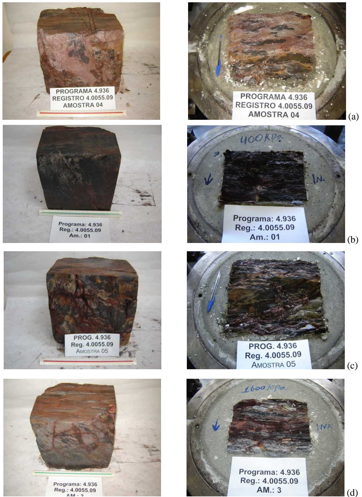
Figura 5.98 - Fotos dos ensaios de cisalhamento direto, com tensão normal de, respectivamente, (a) 204kPa, (b) 407kPa, (c) 804kPa e (d) 1607 kPa. (Furnas, 2009).
