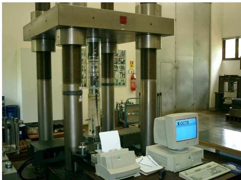
Figura 5.53 - Sistema servo-controlado para ensaios de compressão.
