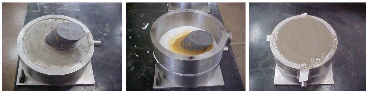
Figura 5.70 - Preparação de corpo de prova para ensaio de cisalhamento direto.
