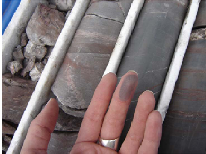
Figura 5.11 - Filito inicialmente identificado em campo como grafitoso, e posteriormente em laboratório como carbonoso (Foto: Malafaia, 2007).
