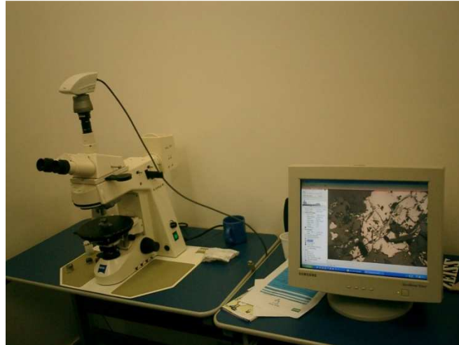
Figura 5.2 - Microscópio de luz transmitida para a análise petrográfica.
