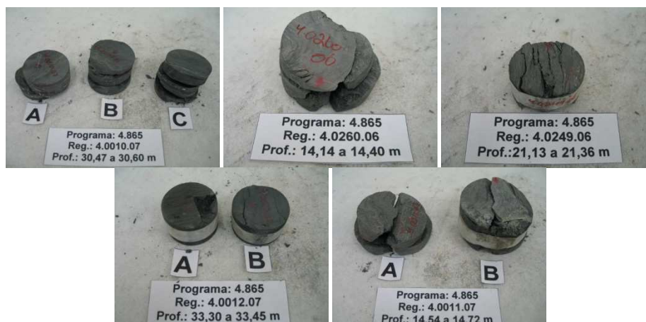
Figura B.30- Registros fotográficos dos corpos de prova ensaiados por compressão diametral – filito grafitoso-.
