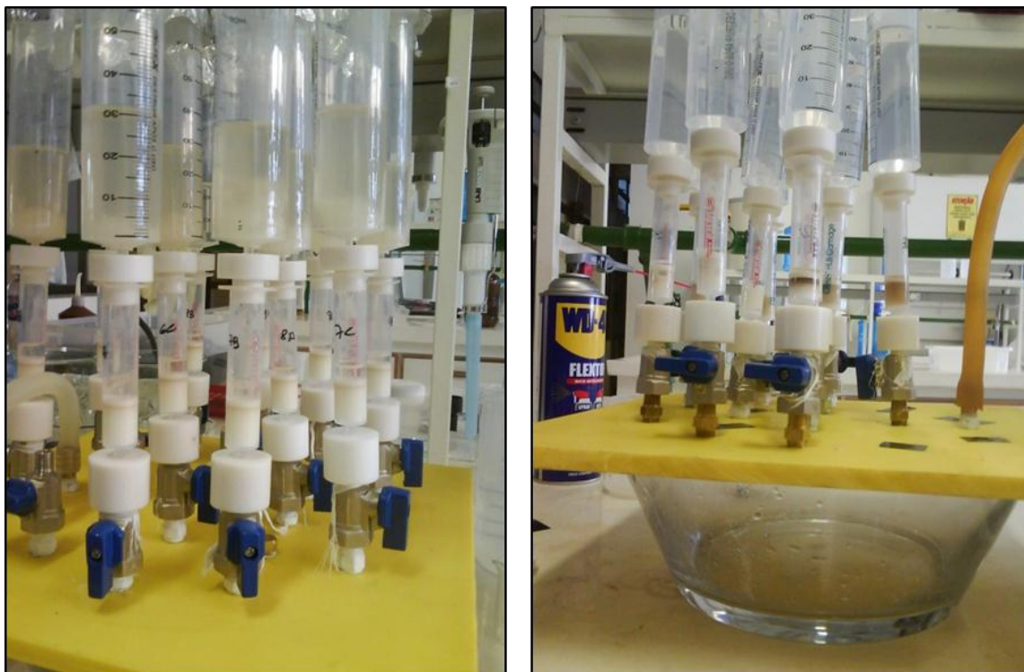
Figura 10. Sistema empregado para extração em fase sólida de COC e BE em amostras de esgoto bruto.
