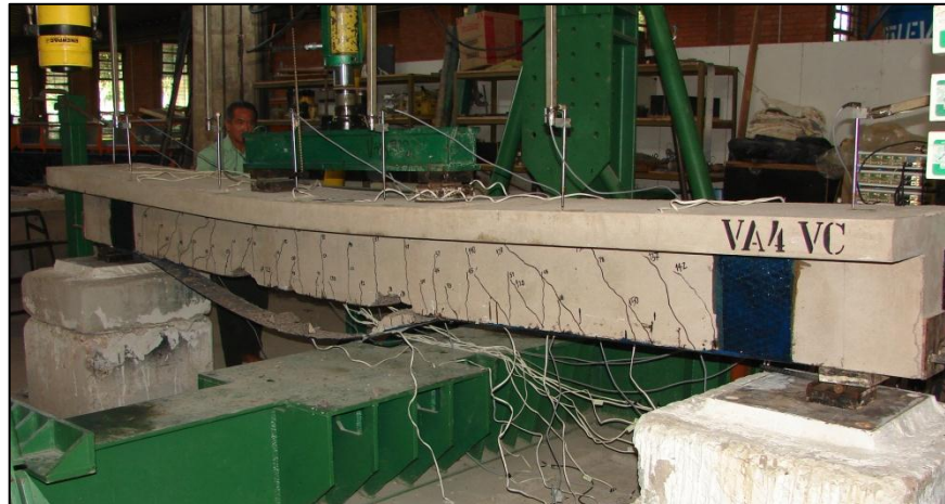
Figura 4.32 – Viga reforçada VA4 - VC após o ensaio
