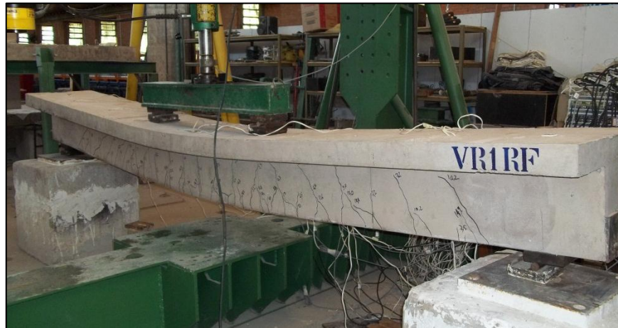
Figura 4.5 – Viga VR1 - RF após o ensaio
