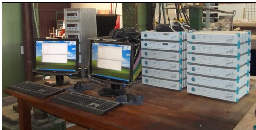
Figura 3.7 – Sistema de aquisição de dados (Spider8)
