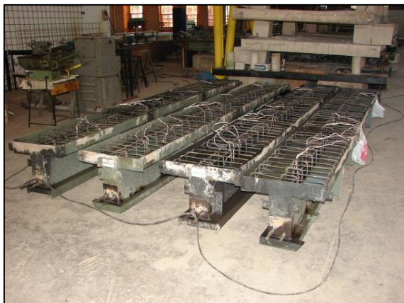
Figura 3.16 – Detalhe das formas
