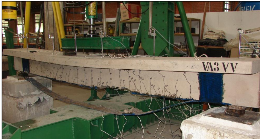
Figura 4.25 – Viga reforçada VA3 - VV após o ensaio
