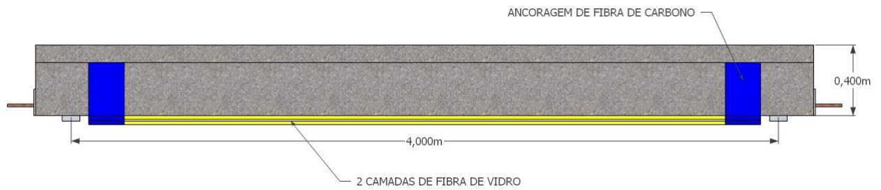
Figura 3.23 – Configuração de colagem da fibra viga VA3 - VV
