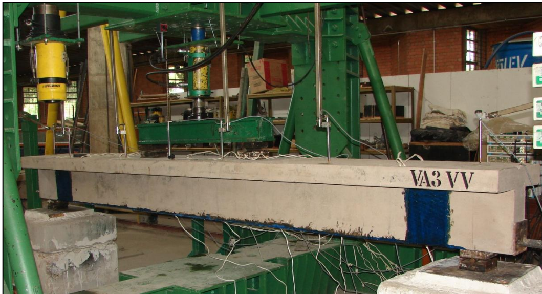
Figura 3.14 – Vista dos defletômetros
