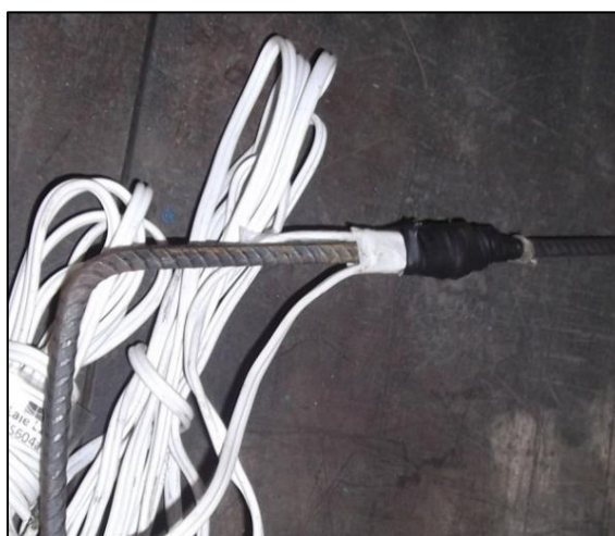
(d) Proteção do extensômetro
