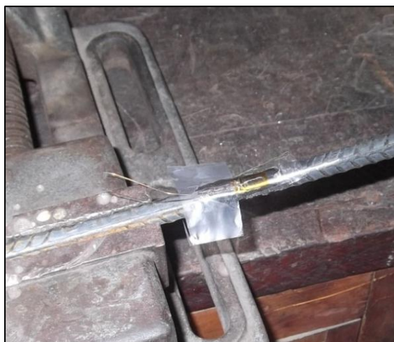
(b) Colagem do extensômetro
