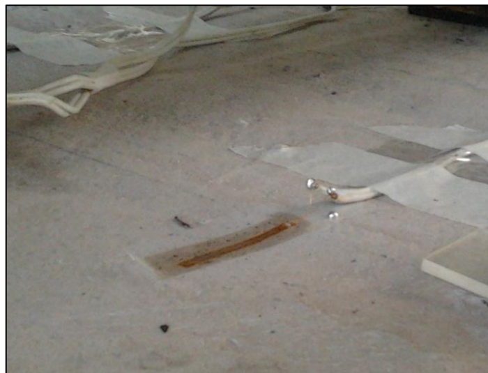
Figura 3.11 – Colagem do extensômetro elétrico no concreto
