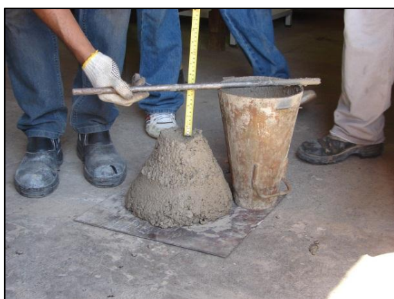
Figura 3.18 – Ensaio de tronco de cone
