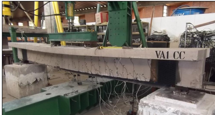
Figura 4.11 – Viga reforçada VA1 - CC após o ensaio
