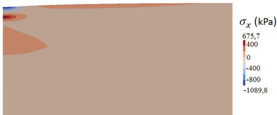
Figura 6.6 – Tensão normal horizontal, direção x ,tração representada por valores positivos.
