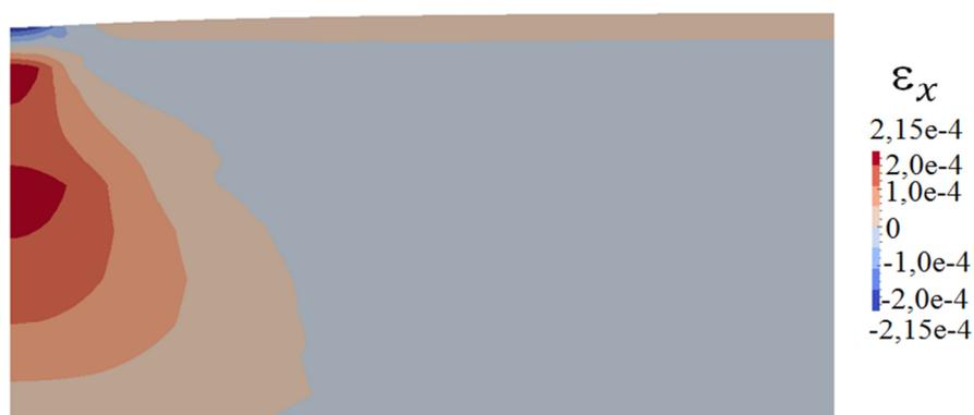
Figura 6.5 – Deformações na direção x, tração representada por valores positivos
