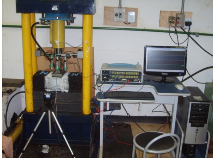
Figura 3.15 Equipamento para ensaio de modelo físico vigas CBUQ.
