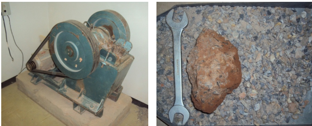
Figura 3.3 Britagem secundaria RCD: (a) Britador de mandíbulas laboratório de geociências; (b) RCD após britagem secundaria.
