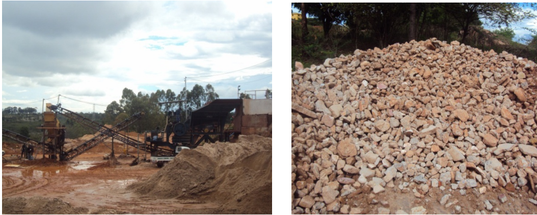
Figura 3.2 Britagem RCD empresa areia bela vista: (a) Britador de mandíbulas; (b) RCD depois da britagem primária.
