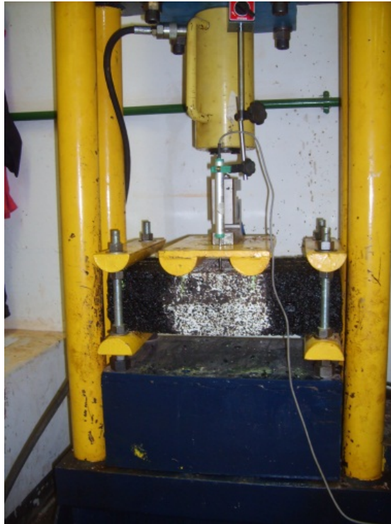
Figura 5.16 Arranjo do ensaio de flexão.
