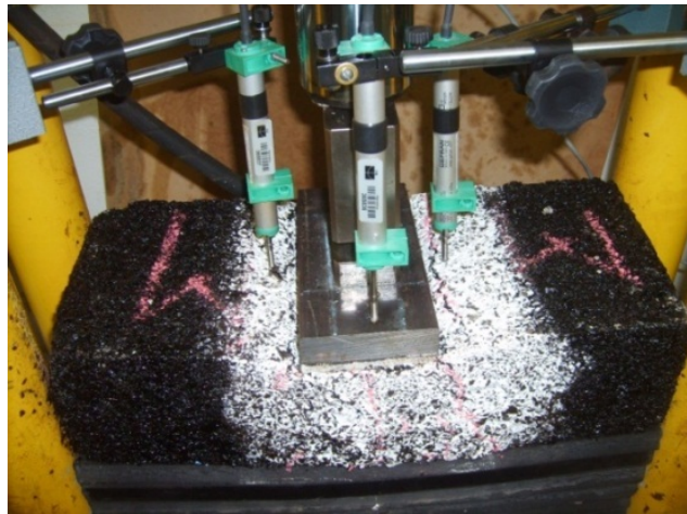
Figura 3.19 Medidores de deslocamento linear.
