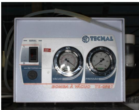
Figuras 15 e 16: Aparelho utilizado para evaporação dos espécimes.
