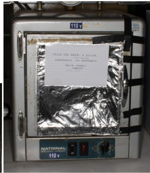
Figuras 2 e 3: Estufa mantida a 37°C para armazenagem dos espécimes.
