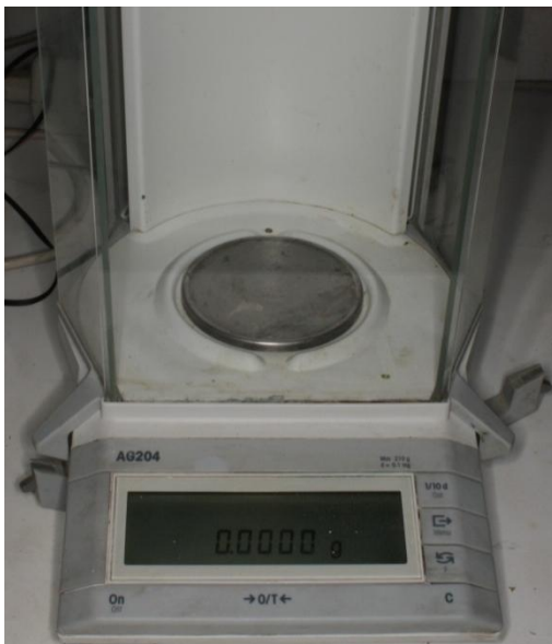
Figura 1: Balança de precisão utilizada para pesagem dos espécimes.
