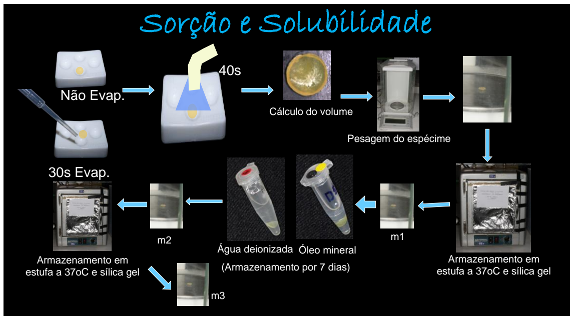
Figura 8: Sequência passo-a-passo dos testes de sorção e solubilidade.
