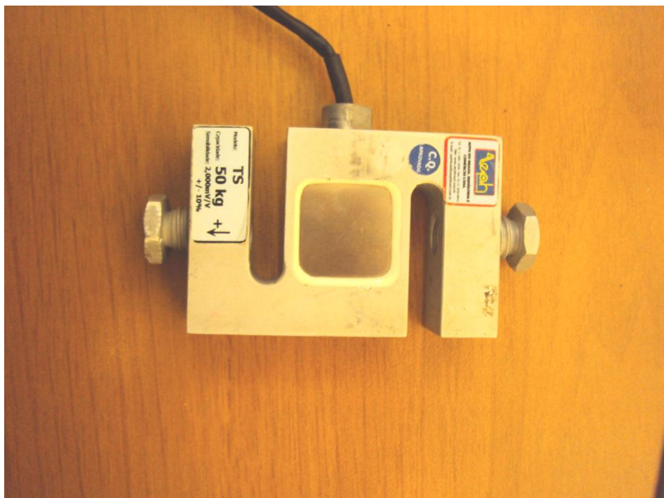
Figura 4 - Célula de carga utilizada. Fabricante: AEPH do BRASIL Ind. e Com Ltda.
