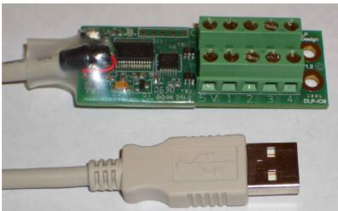
Figura 6 – Placa DLP-IO8-G, da DLP Design Inc., para aquisição de dados com 8 canais.
